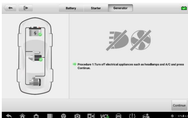
Рисунок 9-11. Пример окна проверки генератора переменного тока
