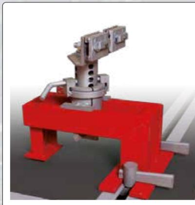
Для закрепления автомобиля на стенде используются регулируемые стойки с зажимами, которые жестко фиксируются на раме с помощью кронштейнов и клиньев. Губки зажимов имеют специальную форму и крупные острые зубья, что полностью исключает вырывание отбортовки при правке. Для установки автомобиля на стенд необходимо использование домкратов.
