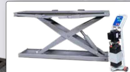
Опционально поставляется ножничный подъемник, который облегчает установку автомобиля на стапель и позволяет работать на более удобных высотах.
