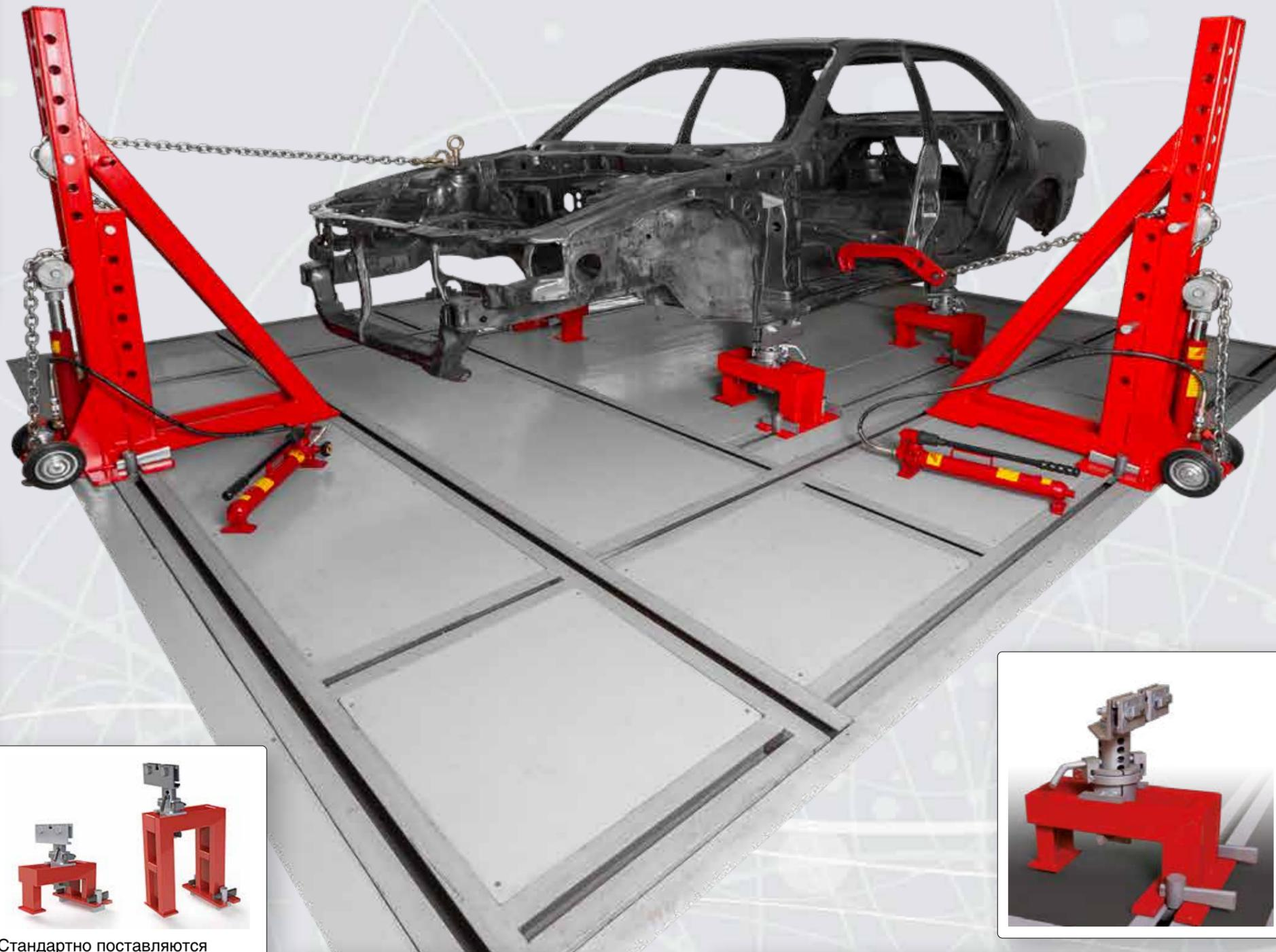
Для правки используются передвижные силовые устройства с усилием вытяжки 10 тонн. Фиксация силового устройства производится в любом необходимом месте на раме с помощью кронштейнов и клиньев, после чего можно сразу приступить к вытяжке. Переставляемые блоки позволяют более точно устанавливать направление вытяжки.
