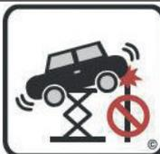
Не устанавливайте никаких подпорных шестов под автомобилем и опустите его при необходимости снятия детали с поднятого автомобиля
