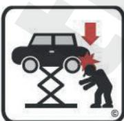
Не стойте под автомобилем во время работы подъемника. Если подъемник зафиксирован для работы в сравнительно низком положении, есть риск столкновения с выступающими частями
