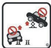
Не поднимайте автомобиль с одной стороны. Автомобиль может перевернуться, и/или может произойти повреждение подъемника
