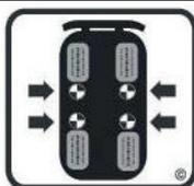
При подъеме автомобиля используйте точки подъема, предусмотренные его производителем
