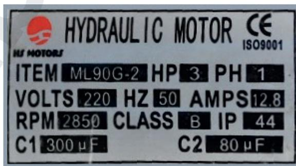
Электромотор 1Ф.х230 В
