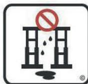
Не эксплуатируйте подъемник, если обнаружите утечку гидравлической жидкости в зоне подъема. Не эксплуатируйте неисправный подъемник
